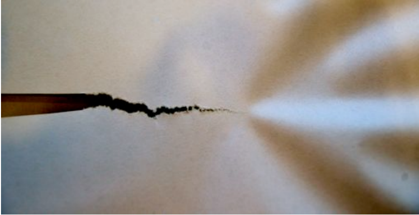
Fig. 1 (Gauche): Une expérience de rupture à laquelle nous sommes régulièrement confrontés, et pourtant, encore mal comprise: le déchirement d'une feuille de papier. (Droite): Caractérisation des trajectoires de fissure: différence de hauteur \Delta h entre deux points distants de \delta x dans le plan de fissuration pour deux matériaux différents. La relation \Delta h \sim \delta x^H indique une géométrie auto-affine caractérisée par l'exposant de rugosité H qui correspond à la pente de \Delta h(\delta x) dans cette échelle logarithmique. Les valeurs différentes de H indiquent deux comportements à rupture différents que l'on cherchera à identifier au cours de ce stage.
